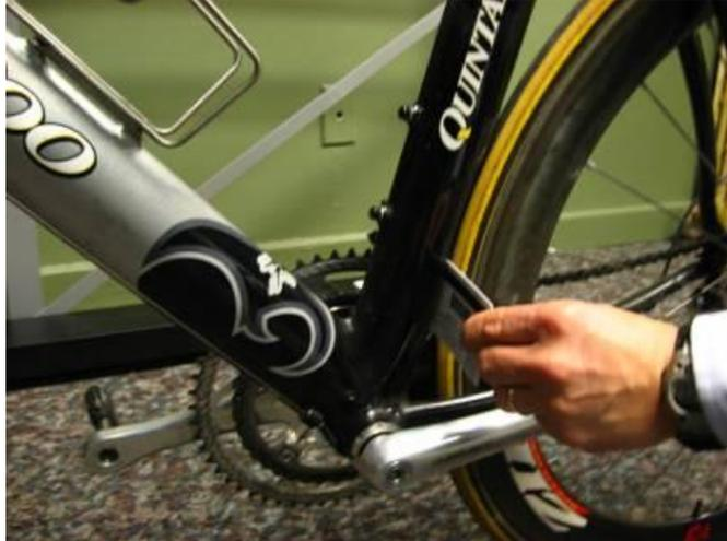
*Figura 60: Inserción de una tarjeta de crédito entre la rueda y el cuadro para comprobar que no hay carenado*
