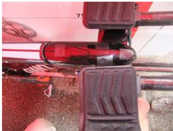
Figura 4: Ilustración de la adición de cinta adhesiva para cubrir el acceso a los pernos
