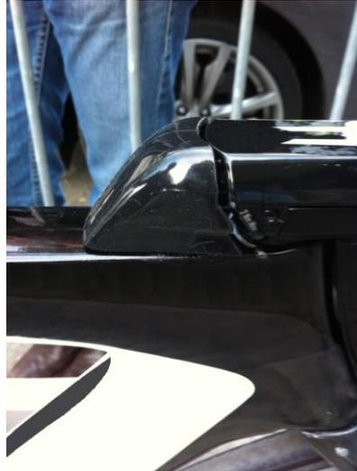
Figura 54: Cubierta agregada al marco para ocultar los cables de freno
