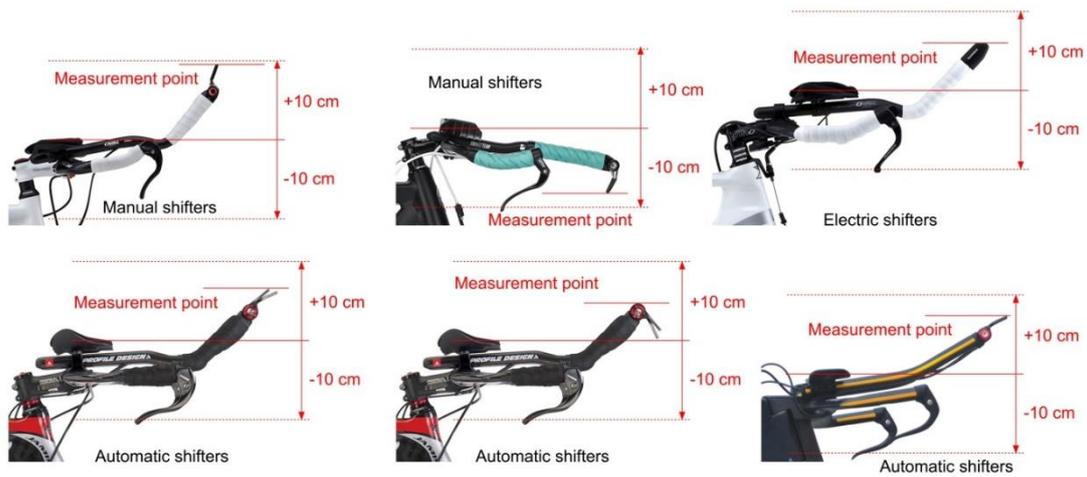
Figura 48: Puntos de medición de los límites verticales de las extensiones adicionales fijas contrarreloj y sus eventuales accesorios
