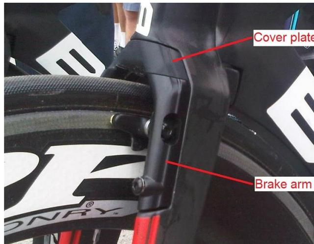
Figura 55: Freno integrado en la horquilla y provisto de tapa
