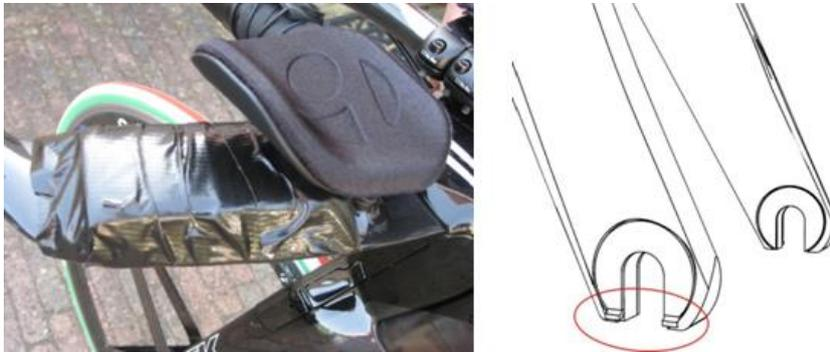
Figura 1: Ejemplos de modificación prohibida de [equipo](#) (adición de cinta, limado de los seguros de caída de la horquilla)
