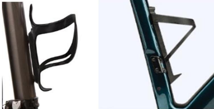
*Figura 61 Ilustración de un espacio físico (izquierda) y visual (derecha) entre la botella y el tubo al que está unida.*
